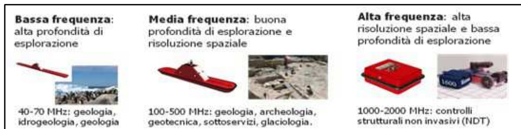
Fig.5. Diversi tipi di antenne GPR e loro utilizzi.
