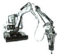
Escavatore con martello demolitore
